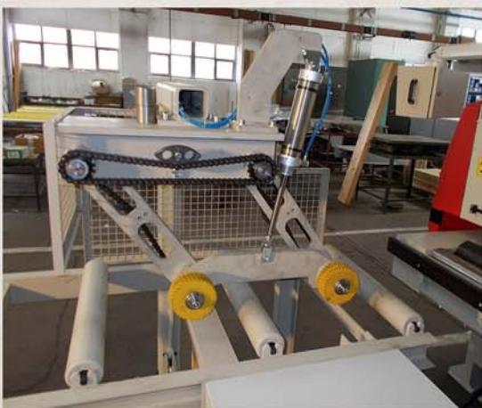
Vkladač je poháněn frekvenčně řízeným motorem.
