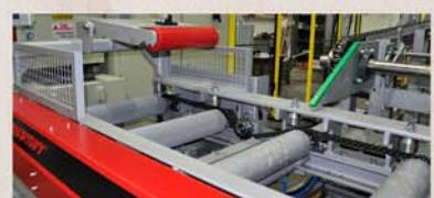
**vkládací dopravník podstatným způsobem zvyšuje bezpečnost při práci na rozmítací pile**
